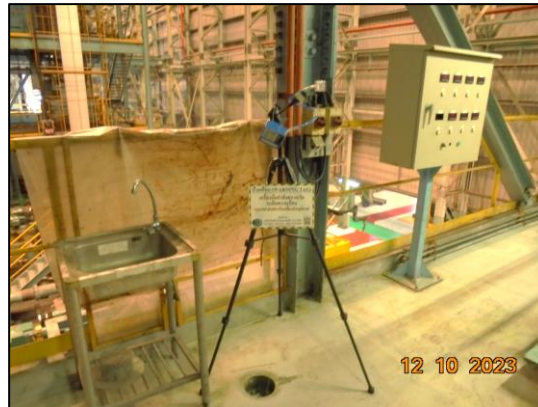
รูปที่ 3.29 การตรวจวัดคุณภาพอากาศในพื้นที่ทำงาน บริเวณ Passivation ในสายการผลิต Zincalume Line MCL1
