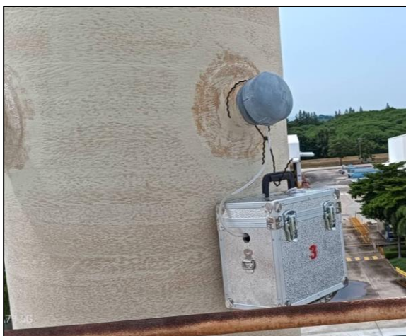
รูปที่ 3.6 การเก็บตัวอย่างคุณภาพอากาศในปล่องระบาย บริเวณ Pickle Line Fume Stack PKL (S1)
