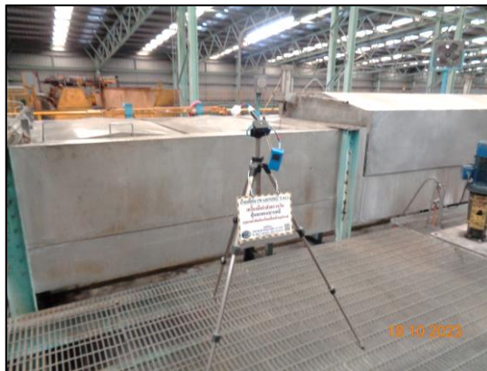
รูปที่ 3.32 การตรวจวัดคุณภาพอากาศในพื้นที่ทำงาน บริเวณ Alkaline Cleaning Section (CPL Process Section)
