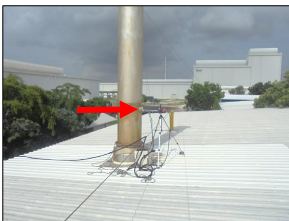
รูปที่ 3.7 การเก็บตัวอย่างคุณภาพอากาศในปล่องระบาย บริเวณ WWTP Sludge Dryer (S14)
