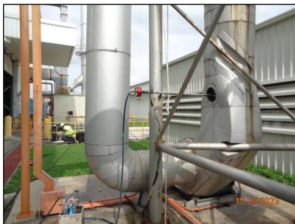
รูปที่ 3.3 การเก็บตัวอย่างคุณภาพอากาศในปล่องระบาย บริเวณ ROPT Oven Stack CPL (S12)
