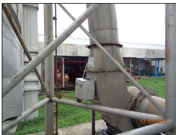
รูปที่ 3.12 การเก็บตัวอย่างคุณภาพอากาศในปล่องระบาย บริเวณ Alkali Cleaning Stack CPL (S11)
