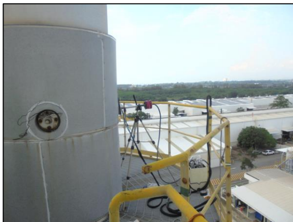
รูปที่ 3.2 การเก็บตัวอย่างคุณภาพอากาศในปล่องระบาย บริเวณ Furnace Stack MCL2 (S8)
