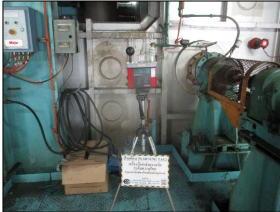
รูปที่ 3.48 การตรวจวัดระดับความร้อนในพื้นที่ทำงาน บริเวณ Zincalume Line Cleaning : MCL 1
