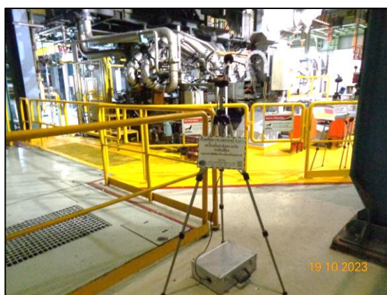
รูปที่ 3.44 การตรวจวัดระดับเสียงในพื้นที่ทำงาน ( L_{eq} 8 hr.) บริเวณ Zincalume Pot Area (MCL 2)
