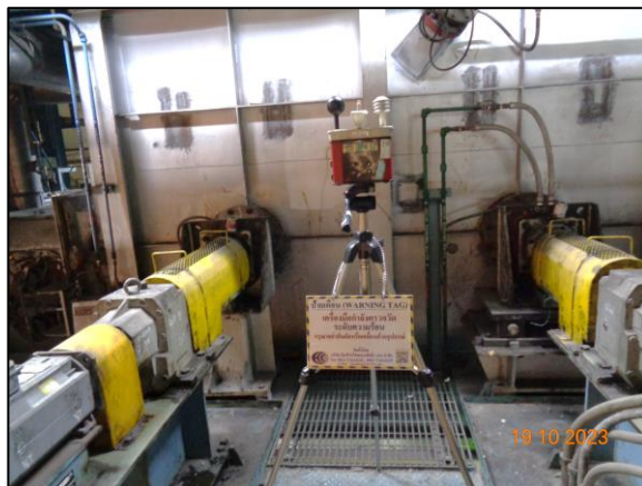
รูปที่ 3.51 การตรวจวัดระดับความร้อนในพื้นที่ทำงาน บริเวณ Annealing Process : MCL 2
