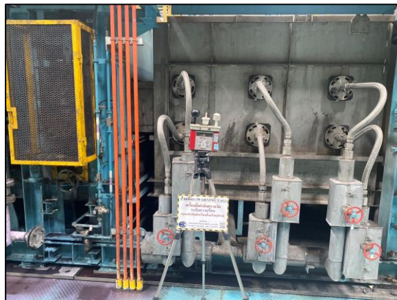
รูปที่ 3.55 การตรวจวัดระดับความร้อนในพื้นที่ทำงาน บริเวณ Annealing Process : MCL 3
