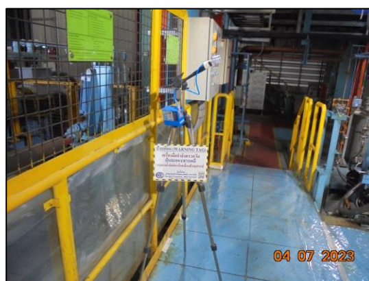
รูปที่ 3.31 การตรวจวัดคุณภาพอากาศในพื้นที่ทำงาน บริเวณ Passivation ในสายการผลิต Zincalume Line MCL3
