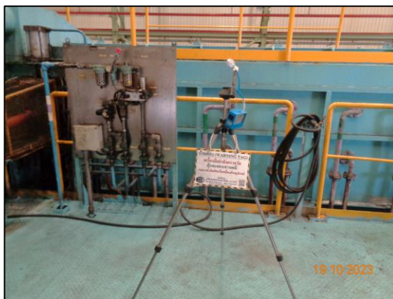
รูปที่ 3.34 การตรวจวัดคุณภาพอากาศในพื้นที่ทำงาน บริเวณ Alkaline Cleaning Section (MCL2)
