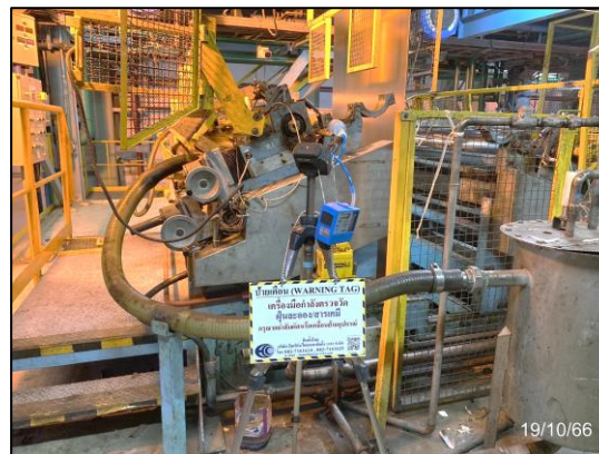
รูปที่ 3.30 การตรวจวัดคุณภาพอากาศในพื้นที่ทำงาน บริเวณ Passivation ในสายการผลิต Zincalume Line MCL2
